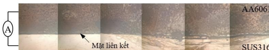
Hình 2.3. Sơ đồ ăn mòn điện hóa môi hàn AA6061/SUS316
